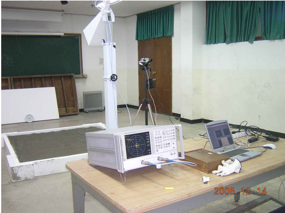
그림 7. PolScat을 이용한 실내 갯벌 건조실험 현장.
